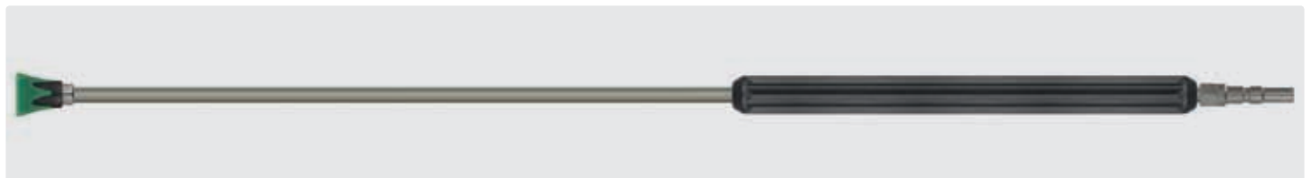
Stecknippel KW. Strahlrohr aus Edelstahl, umspritze Isolierung 400 mm und Düzenschutz ST-10 ohne Düse. Max. 400 bar / 150 °C
