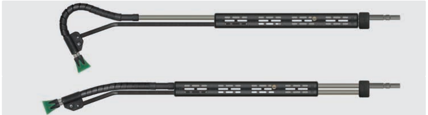
Stecknippel KW. Strahlrohr aus Edelstahl, Isolierung ST-9 380 mm und Düzenschutz ST-10 ohne Düse. Stufenlose Verstellung des Biegewinkels der Lanze von 20 - 140°. Sie erreichen jeden Winkel ohne Verrenkungen und mühelos. Max. 210 bar / 150 °C
